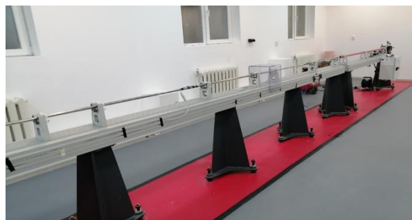
Fig. 11. Split Hopkinson (Kolsky) Pressure Bar (courtesy of IMBAS).
